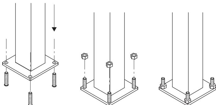
Enfiler la borne carrée inox avec le couvre plaque inox sur le corps de renforcement blindé au moyen de l'anneau de prise inox; puis visser les 4 écrous M16 inox.
