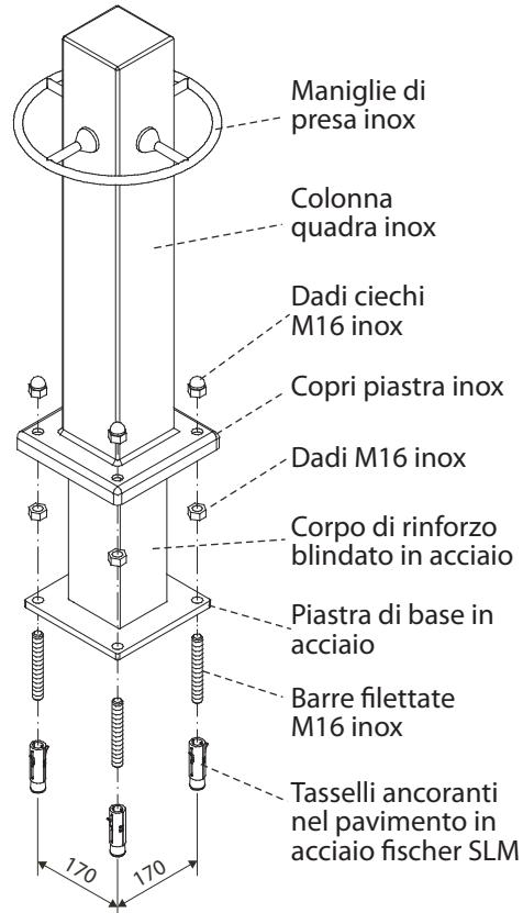
Inserire la piastra di base con il corpo di rinforzo blindato nelle quattro barre filettate inox sporgenti; di seguito avvitare e stringere in maniera sicura i quattro dadi inox M16.
