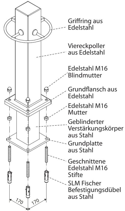
Die Grundplatte mit geblindertem Verstärkungskörper in die vier hervorstehenden geschnittenen Edelstahlstifte einsetzen; danach die vier Edelstahlmutter M16 festschrauben.
