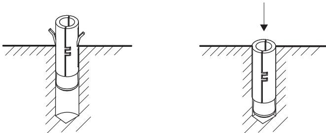
Visser les quatre tiges filetées inox M16 aux 4 chevilles de fixation en acier pour une saine d'environ 35 - 40 mm; serrer l'écrou inox M16 pour régler la cheville qui doit bien adhérer au trou; il faut obtenir une saine des tiges filetées de 45 mm maximum du sol.
