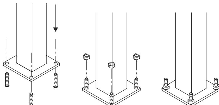
Der viereckige Edelstahl-Absperrpoller auf den geblinderten Verstärkungskörper mittels des runden Griffes montieren; die vier Edelstahl-Blindmutter M16 stark anziehen.
