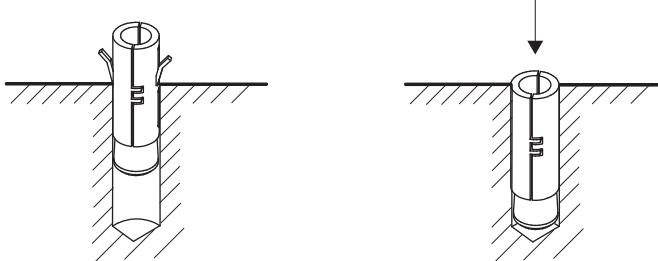
Atornillar las cuatro barras enroscadas M16 en acero inox en los cuatro tacos de anclaje en acero, de manera tal que sobresalgan en unos 35-40 mm aproximadamente; apretar la tuerca M16 en acero inox para tensar el tajo de manera tal que se adhiera rigidamente al agujero, logrando que la barra enroscada sobresalga en relación con el pavimento en unos 45 mm como máximo. Desatornillar y quitar la tuerca M16 en acero inox. Repetir esta operación para todas las cuatro barras enroscadas en acero inox.
